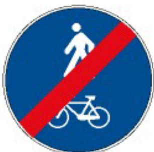
Fig1a: Cartello di inizio e fine percorso pedonale e ciclabile (figg II 92/b e 93/b, art 122, DPR 495/92)
